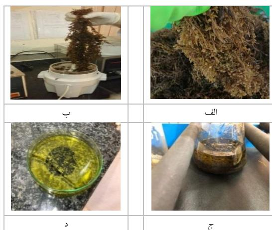
شکل (۲) مراحل استخراج روغن جلبک سارگاسوم بیوویانوم توسط حلال ان-هگزان. نمونه‌ای از جلبک قهقهه‌ای سارگاسوم جمع‌آوری شده از سواحل بوشهر (الف)؛ آسیاب نمودن و هموژناسیون جلبک (ب)؛ استخراج با حلال ان-هگزان (ج)؛ نمونه روغن جمع‌آوری شده از جلبک (د). (عکس: نگارنده)
