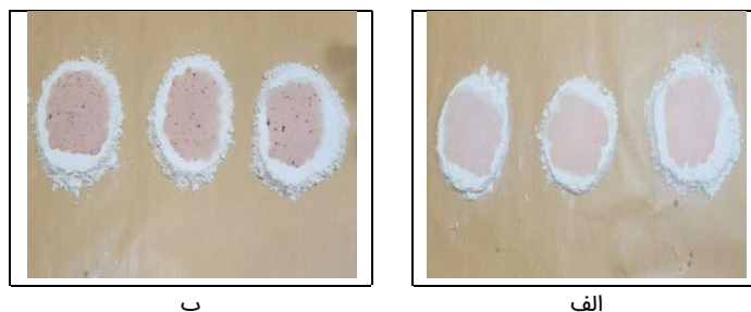
شکل ۳. آزمون نقطه‌ای نمونه آرد جهت تعیین میزان آهن قبل از غنی‌سازی (الف)؛ و پس از غنی‌سازی با آهن (ب). Fig 3. Spot test of flour sample to determine iron content before enrichment (a); and after enrichment with iron (b).
