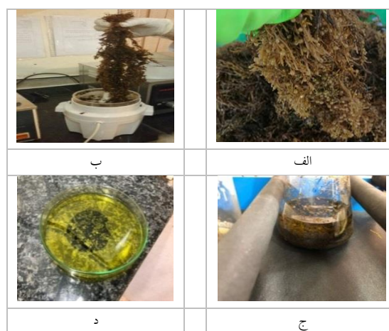
شکل ۲) مراحل استخراج روغن جلبک سارگاسوم بوویانوم توسط حلال ان-هگزان. نمونه‌ای از جلبک قهوه‌ای سارگاسوم جمع‌آوری شده از سواحل بوشهر (الف)؛ آسیاب نمودن و هموژناسیون جلبک (ب)؛ استخراج با حلال ان-هگزان (ج)؛ نمونه روغن جمع‌آوری شده از جلبک (د). (عکس: نگارنده)
