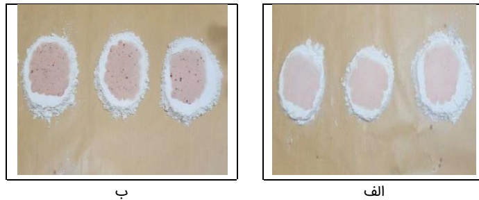
شکل ۳. آزمون نقطه‌ای نمونه آرد جهت تعیین میزان آهن قبل از غنی‌سازی (الف)؛ و پس از غنی‌سازی با آهن (ب). Fig 3. Spot test of flour sample to determine iron content before enrichment (a); and after enrichment with iron (b).
