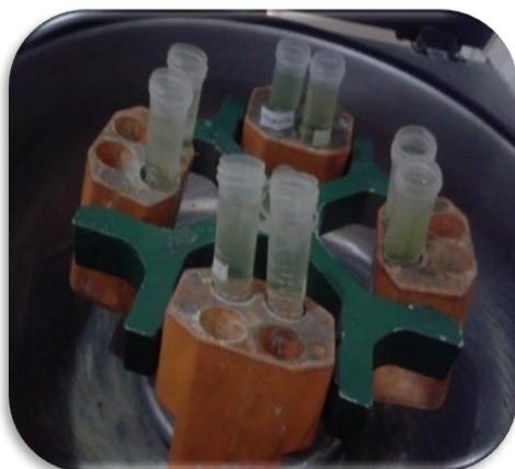
شکل ۴) سانتریفوژ جهت جدا کردن ریز جلبکها
