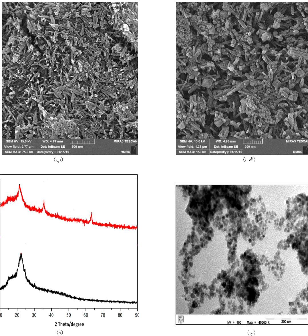
شکل ۱) (الف) آنالیز SEM برای کیتوزان استخراج شده از پوسته میگو در ۱۵ keV، (ب) نمایش مرفو洛ژی سطحی کیتوزان مغناطیسی شده، (ج) پراش اشعه ایکس برای کیتوزان و کیتوزان مغناطیسی شده در محدوده زاویه  $2\theta = 10^\circ \text{ تا } 90^\circ$  با استفاده از تابش Cu  $ka$  در دمای  $25^\circ\text{C}$  و (د) اندازه و شکل نانو ذرات فلزی نشانده شده بر روی کیتوزان به وسیله میکروسکوپ الکترونی انتقالی (TEM) در ۱۰۰ keV.
