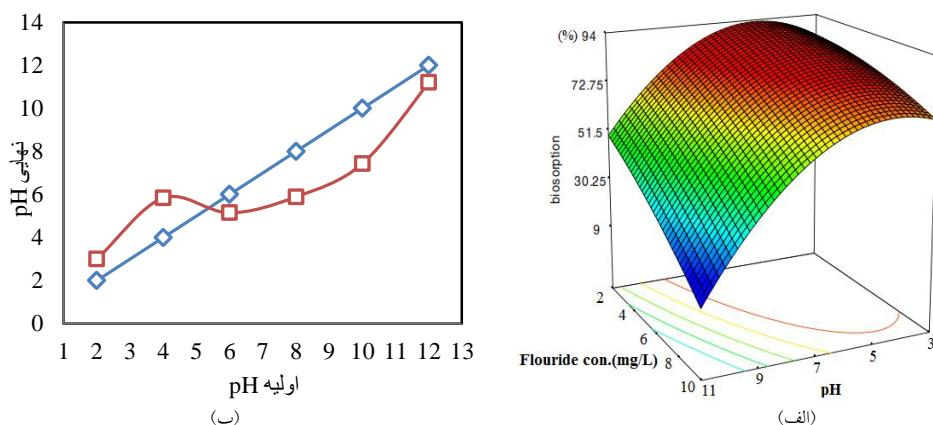
شکل ۳) (الف) اثر pH بر روی درصد حذف فلوراید (غلظت جاذب ۲ گرم در لیتر، زمان ۶۰ دقیقه، دمای محیط) و (ب) pH نقطه بار صفر (pHzpc)
