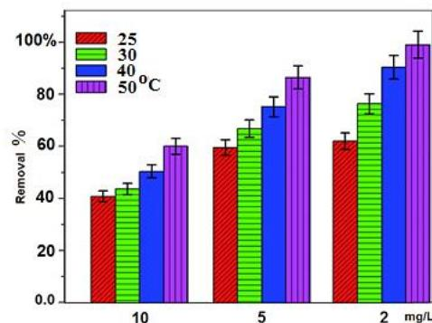
شکل ۶) اثر دما بر درصد حذف فلوراید pH برابر  $5$  زمان  $15$  دقیقه و غلظت جاذب  $1$  گرم بر لیتر
