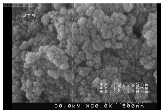
شکل ۵) میکروگراف پودر استخوان ماهی مرکب بعد از افزودن ماده فعال سطحی
